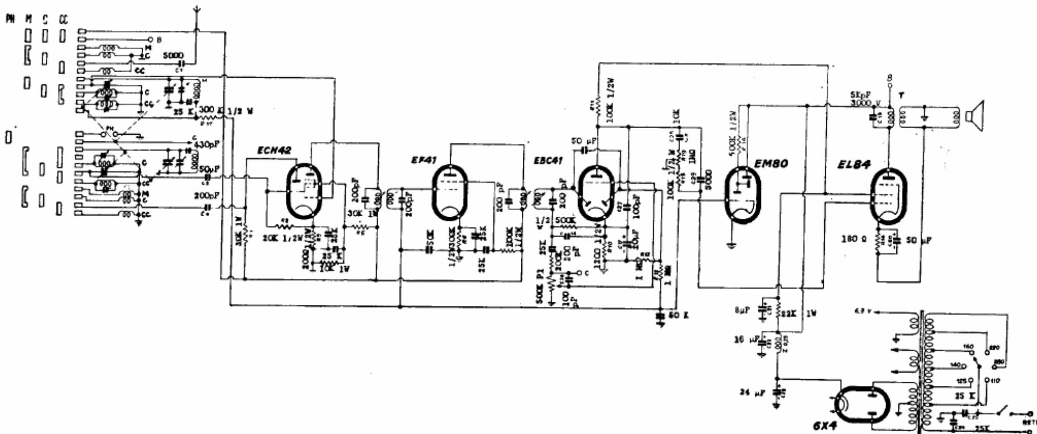
IMCARADIO - Mod. 356 e 3561. Onde medie e due gamme onde corte. Media frequenza 460 kc/s. Controreazione di bassa frequenza sullo stadio finale. Potenza di uscita 3,5 watt. Consumo 55 watt.
